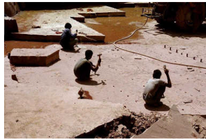
manueller Abbau des Sandsteins
